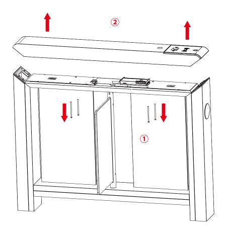
3. Снимите боковые панели, которые крепятся на устройство.
