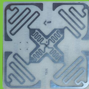
UHF1-Tag7 - это всенаправленная метка использует новейшую технологию True 3D от Impinj и метку с двойной антенной. Эффект считывания не ограничивается антенной считывателя, метку можно хорошо распознать в любом месте вокруг карты. Это важная инновационная технология в области UHF RFID. Область применения включает такие сектора экономики, как, розничная торговля, управление активами и логистика.
