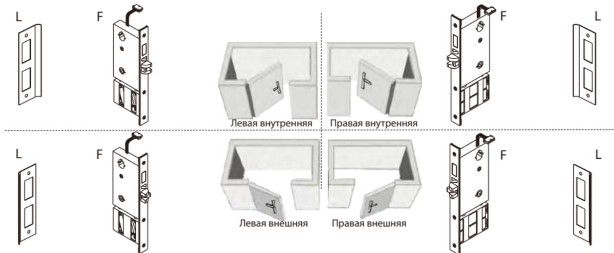
Примечание: Пожалуйста, установите врезной механизм (F) и ответную часть (L) в соответствии с рисунком.
