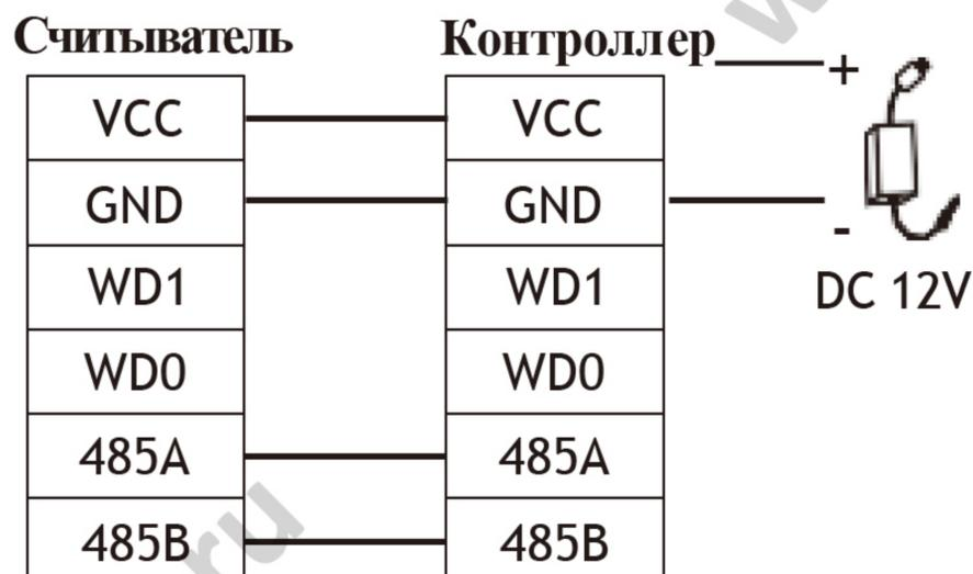
2. Откройте программу DEMO, выберите номер последовательного порта, скорость передачи данных по умолчанию - 115200, нажмите "Подключить" и "Сканировать адрес", затем поместите карту или QR-код (бумажный, электронный, с мобильного телефона) в зону распознавания считывателя карт, чтобы считать информацию с карты. Устройство автоматически получит и передаст информацию, содержащуюся на карте или QR-коде, контроллеру.
